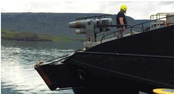
図3. クヴァルル8号の船先に備え付けられたコングスバーク社製90mm捕鯨砲(2018年7月28日撮影)
